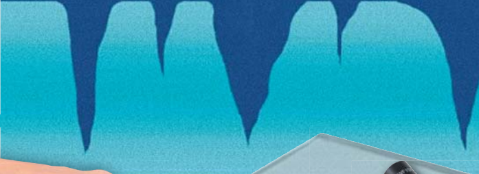
Representação dos “altos” e “baixos” na superfície de uma chapa de vidro plano comum, em escala nanométrica (ampliação medida em bilhões de vezes)
